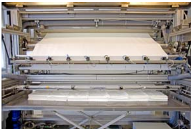
13 - Formatier- und Legestation mit automatischer Tuchablage und Laser-Formatierung
